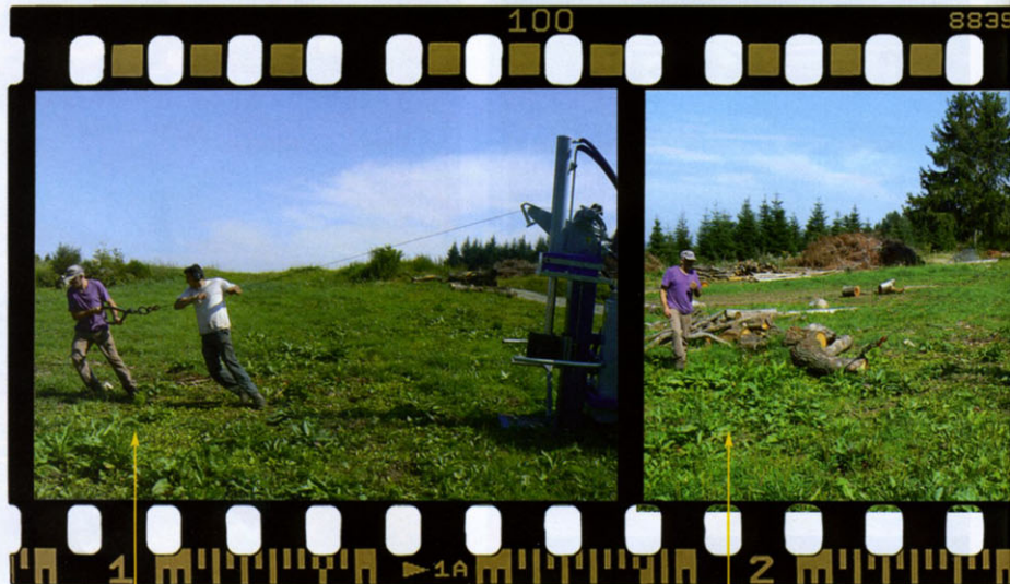
Le treuil doit être tiré manuellement jusqu'au billon à fendre.
