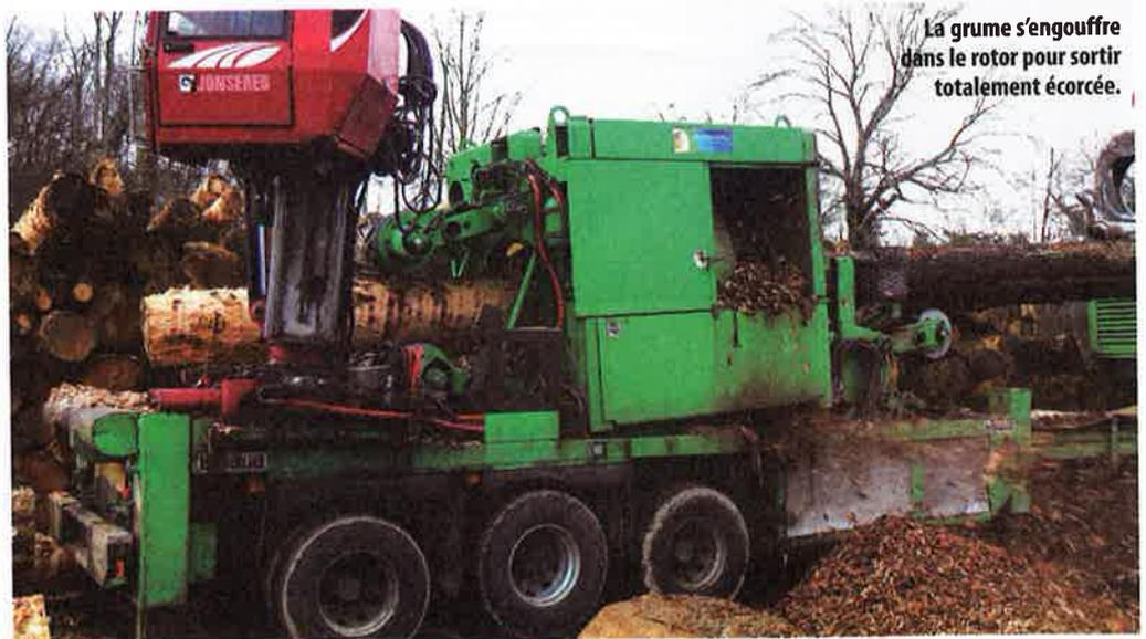
**La grume s'engouffre dans le rotor pour sortir totalement écorcée.**
